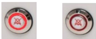
Figura 14.11 Butonul de alarmă care indică alarma
