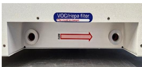
Figura 12.1 Săgeata de flux de pe incubatoarele FIV cu camere multiple MIRI® TL6 și MIRI® TL12
